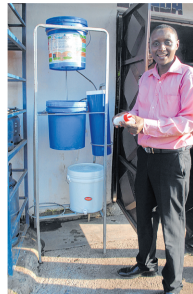
Mit Sand und Nanotechnologie bereitet der Chemieingenieur Askwar Hilonga in Tansania günstig Wasser auf.
